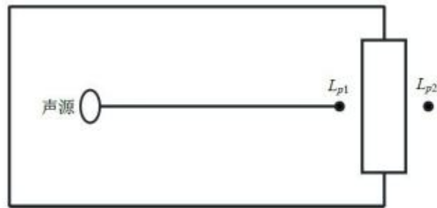
图 4-1 室内声源等效为室外声源图例
