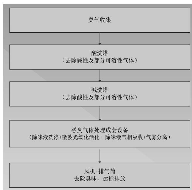
图 3.8-12 主厂房臭气处理工艺流程图
