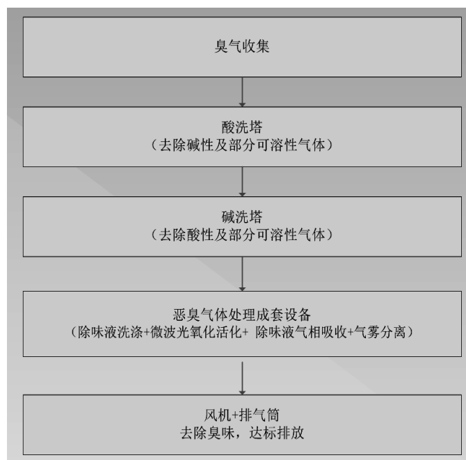
图 7.2-1 主厂房臭气处理工艺流程图
